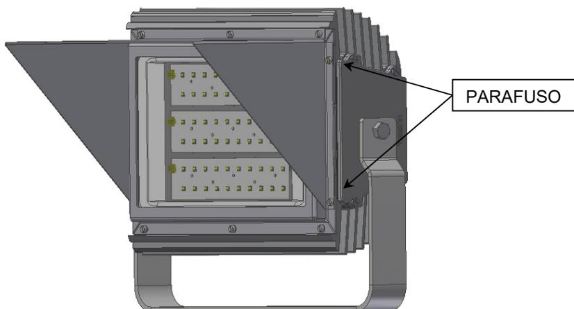
Para instalar uma proteção da montagem das lentes, uma Luminária DEVE estar completamente montada. Instale a proteção na montagem das lentes prendendo a aba da ponta da carcaça da luminária. O encaixe deve ficar firme.
